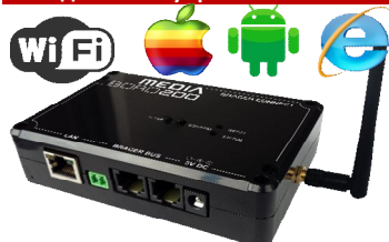
Модуль Интернет-управления котлом
